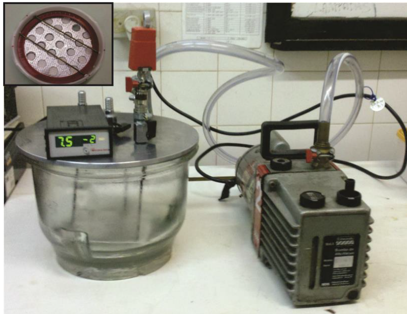
Figura 15: Aparato experimental para imersão e impregnação das amostras com água para medidas de densidade e porosidade [58].
