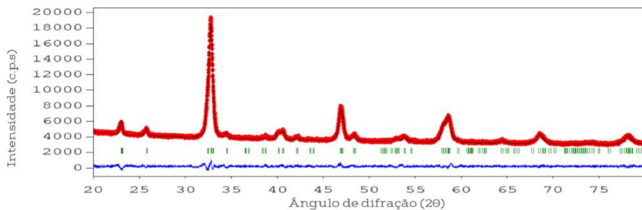
Figura A.21: Refinamento Rietveld da amostra (Ca, Y, La, Nd, Pr)_{0.2}FeO_3 calcinada a 850 °C por uma hora.
