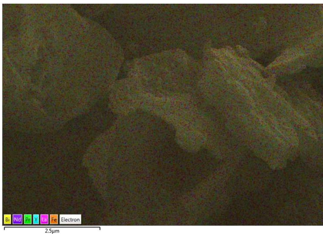
Figura 6.26: Sobreposição, com ampliação de 60.000 vezes, de mapas elementares de distribuição dos cátions presentes na série (Bi, Y, La, Nd, Pr)_{0,2}FeO_3 calcinada a 600 °C por uma hora.
