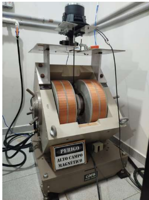
Figura 4.6: Magnetômetro de amostra vibrante utilizado para as caracterizações realizadas nesse trabalho.
