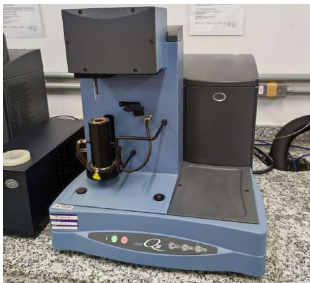
Figura 4.9: Analisador termogravimétrico TGA Q50 utilizado nas análises dessa dissertação.
