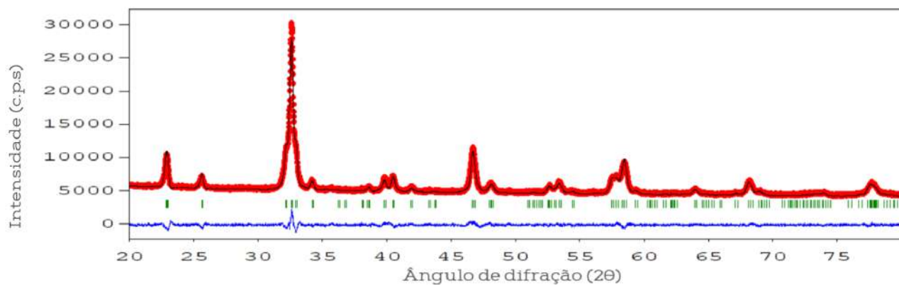
Figura A.27: Refinamento Rietveld da amostra (Bi, Y, La, Nd, Pr)_{0,2}FeO_3 calcinada a 800 °C por uma hora.
