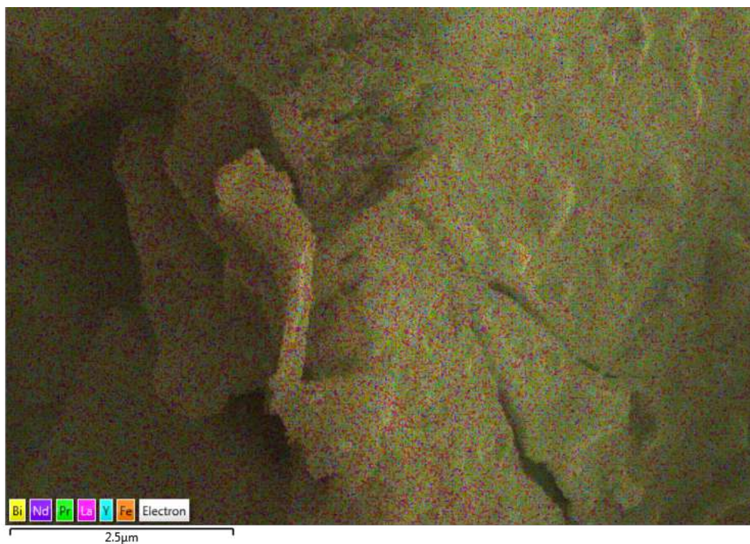
Figura 6.27: Sobreposição, com ampliação de 60.000 vezes, de mapas elementares de distribuição dos cátions presentes na série (Bi, Y, La, Nd, Pr)_{0,2}FeO_3 calcinada a 700 °C por uma hora.
