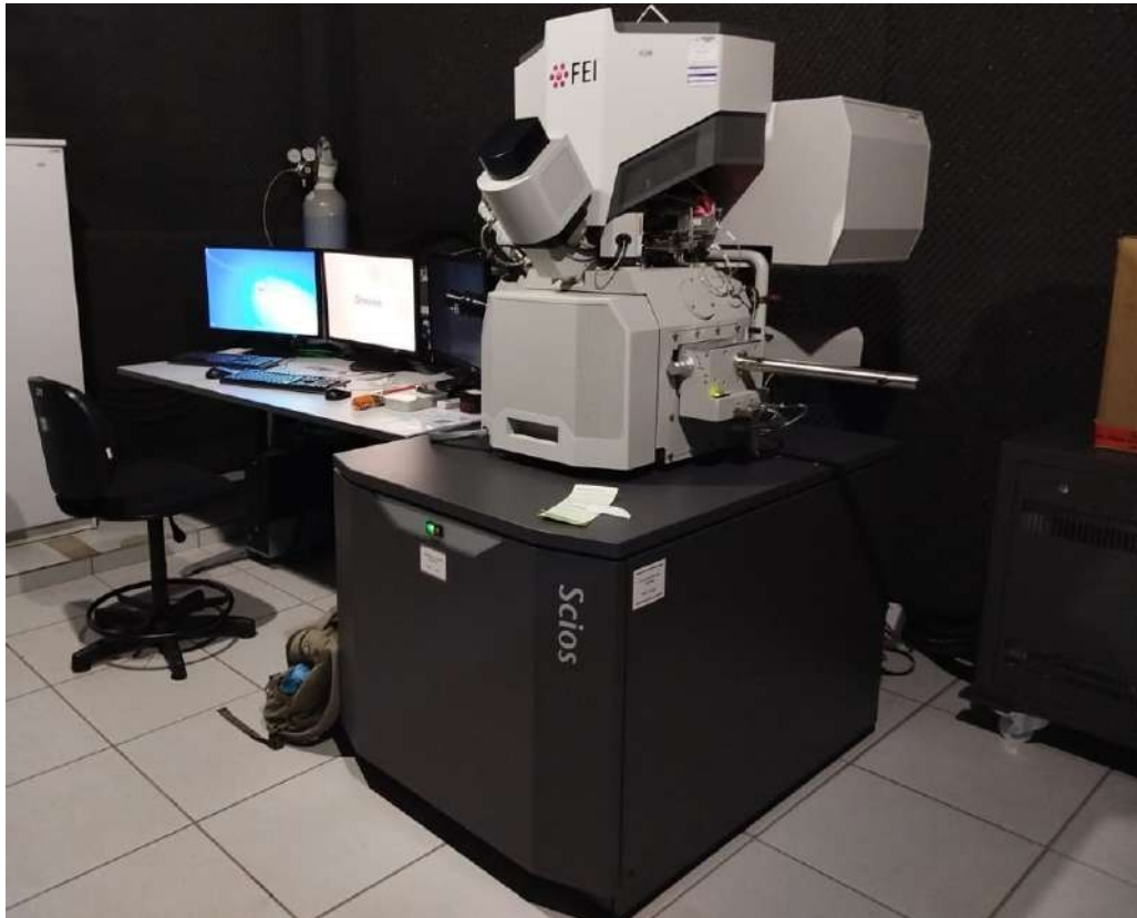
Figura 4.8: Microscópio eletrônico de alta resolução FEI - SCIOS, utilizado para as análises de microscopia eletrônica de varredura (modo IES) e espectroscopia de raios X por dispersão de energia.
