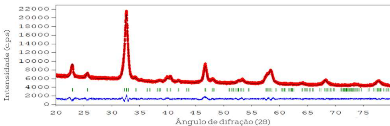
Figura A.23: Refinamento Rietveld da amostra (Bi, Y, La, Nd, Pr)_{0,2}FeO_3 calcinada a 600 °C por uma hora.
