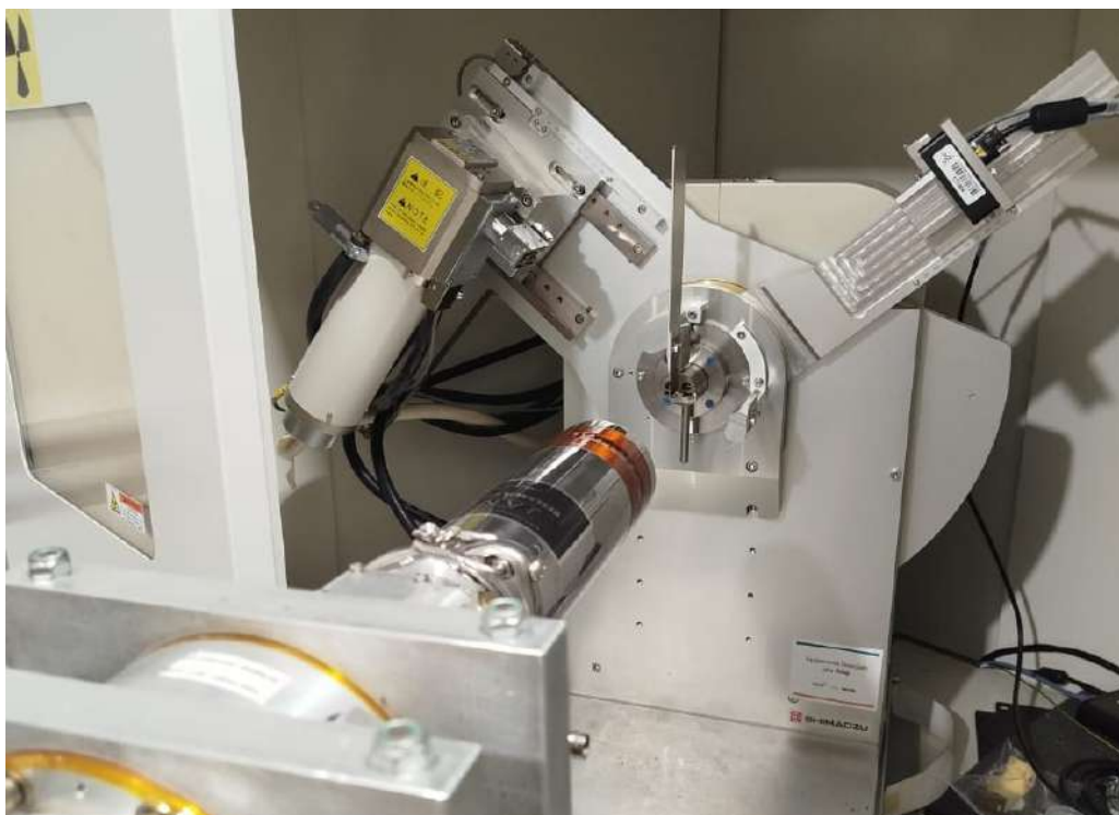
Figura 4.3: Difratorômetro Shimadzu XRD 7000, utilizado na obtenção dos difratogramas desse trabalho.
