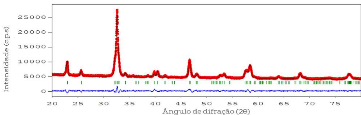
Figura A.26: Refinamento Rietveld da amostra (Bi, Y, La, Nd, Pr)_{0,2}FeO_3 calcinada a 750 °C por uma hora.
