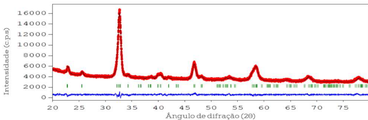
Figura A.16: Refinamento Rietveld da amostra (Ca, Y, La, Nd, Pr)_{0.2}FeO_3 calcinada a 600 °C por uma hora.
