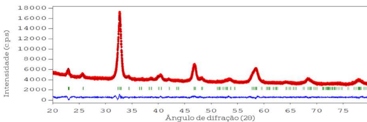
Figura A.17: Refinamento Rietveld da amostra (Ca, Y, La, Nd, Pr)_{0.2}FeO_3 calcinada a 650 °C por uma hora.
