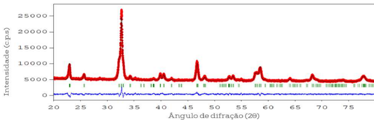
Figura A.28: Refinamento Rietveld da amostra (Bi, Y, La, Nd, Pr)_{0,2}FeO_3 calcinada a 850 °C por uma hora.
