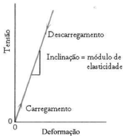
Figura 2.4: Ilustração da reta tensão-deformação mostrando a deformação elástica linear para ciclos de carga e descarga, adaptado de [4].
