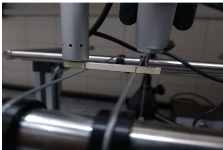
Figura 4.1: Imagem do posicionamento da amostra para o ensaio de excitação por impulso da cerâmica BTNN, apoiada em seus pontos nodais por cabos do suporte ajustável de barras e cilindros, modelo SA_BC.
