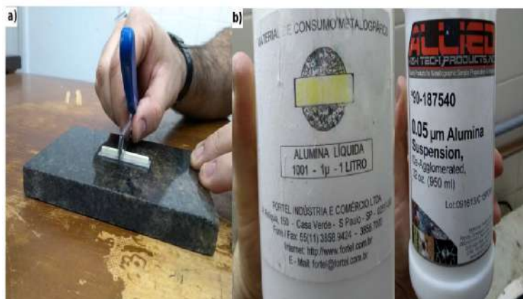
Figura 4.6: a) Entalhe na amostra sendo realizado com lâmina de barbear fixada em uma placa de granito com fita dupla face. b) Reservatório de Alumina líquida de granulação de 1 \mu m e de 0,05 \mu m.
