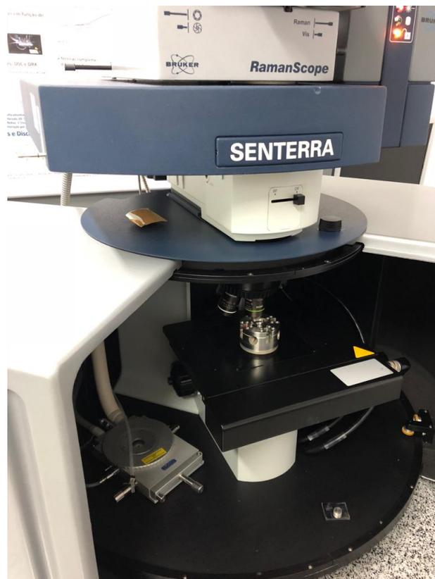
Figura 3.9: DAC dentro do microscópio Raman.
