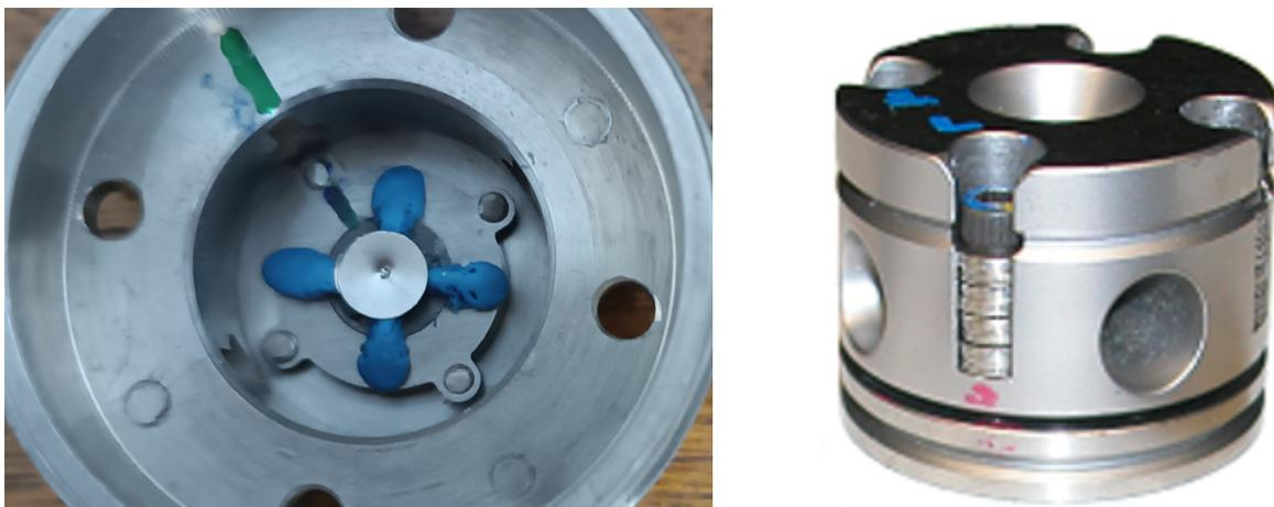
Figura 3.4: (a): *gasket* fixado com massa de modelar. (b) DAC fechada.
