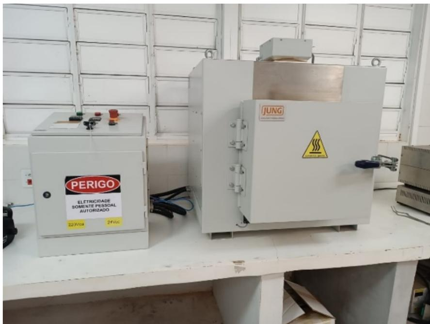
Figura 3.1: Forno do tipo mufla da marca JUNG.
