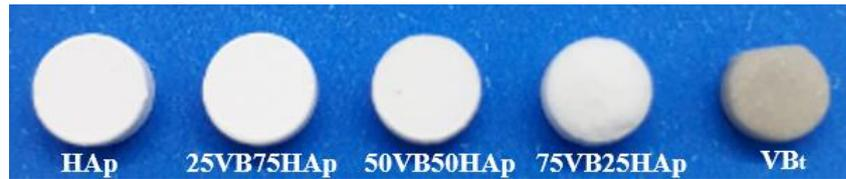
**Figura 3. 2:** Amostras após tratamento térmico. (VB<sub>t</sub>: Vidro Bioativo tratado termicamente)
