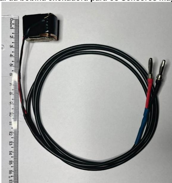
A segunda bobina, denominada bobina fonte de campo, foi construída utilizando fio de cobre esmaltado de 25 AWG, com quatro camadas de enrolamento, totalizando 274 voltas. A bobina possui formato retangular, com 2,5 cm de largura, 2 cm de altura e 2 cm de profundidade. Ela é conectada a um cabo de duas vias, com terminação em conectores do tipo "banana", semelhante à bobina excitadora, o que permite sua ligação ao amplificador de potência.
