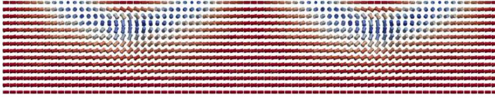
Figura 4.10: Vista lateral dos spins de meia amostra de ZLI4330, em uma célula de espessura d = 12 e periodicidade \Lambda = 18 . Em vermelho estão representados os spins paralelos à coordenada x e em y os spins perpendiculares. Fonte: Imagem adaptada da referência [64]
