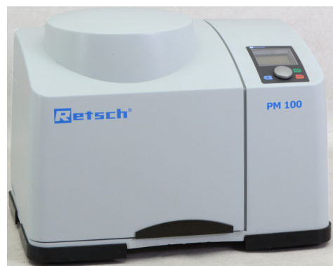
Figura 5.2 – Moinho planetário Retsch, modelo PM100.
