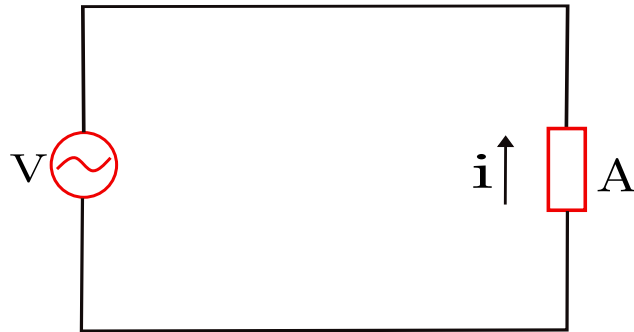
Figura 3.5 – Circuito com uma fonte de corrente alternada V e um componente genérico A percorrido por uma corrente elétrica i .
