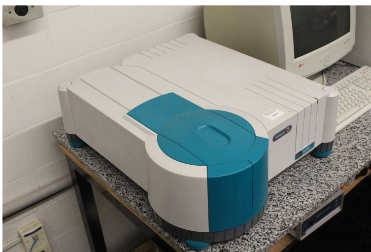
Figura 2.1: Espectrofotômetro UV/VIS modelo Cary 50 utilizado.
