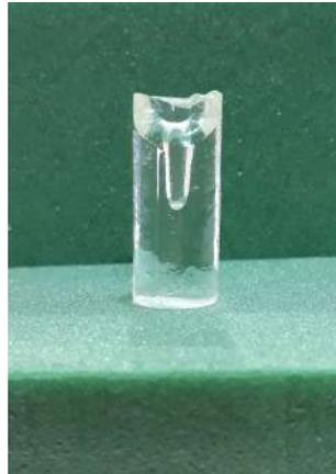
Figura 2.1: Vidro final obtido após recozimento em 450 °C durante 5 horas.
