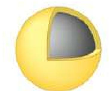
**Figura 2.5:** Ilustração de NPMs com estrutura caroço/casca [6].
