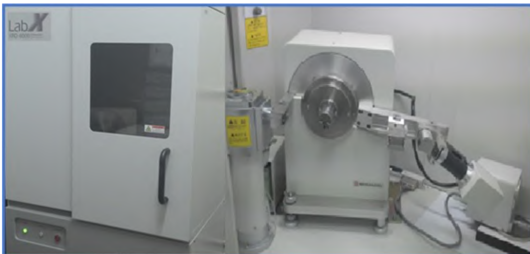
Figura 67 – Difratorômetro de raios-X utilizado na análise estrutural (Shimadzu XRD-6000).
