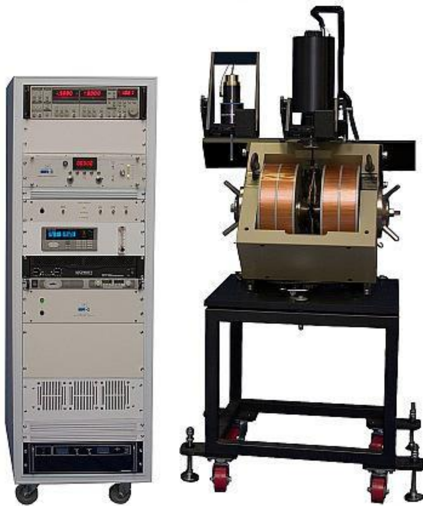
Figura 19 – Magnetômetro de amostra vibrante utilizado nas medidas de magnetização. (EV9 - Microsence).
