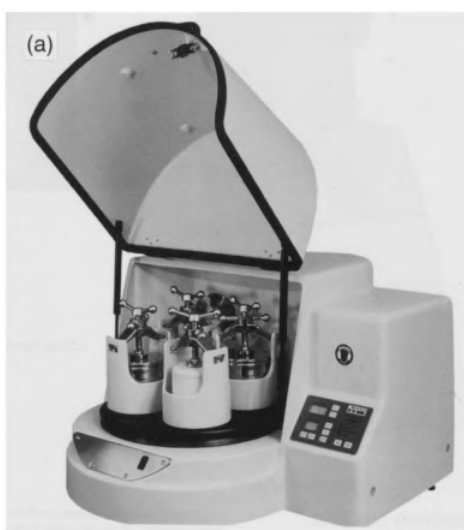
Figura 1.3: Moinho de bolas do tipo planetário da marca Fritsch Pulverisette P-5 [33].
