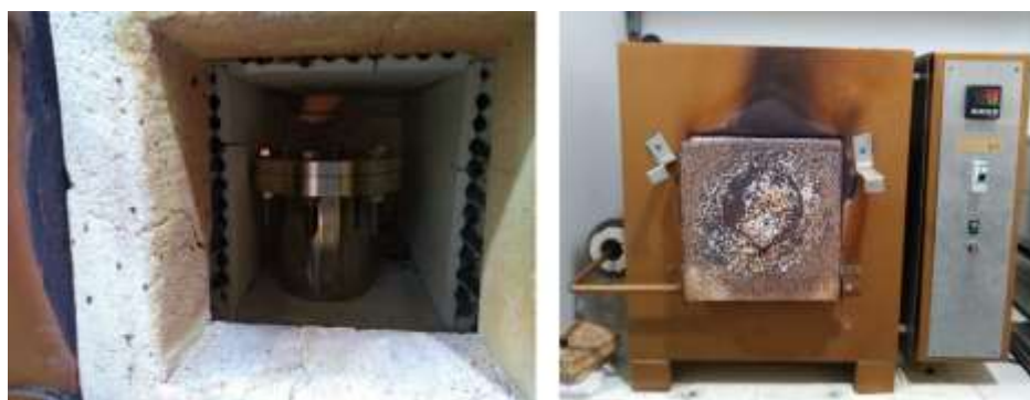
Figura 41: Forno utilizado na síntese hidrotérmica
