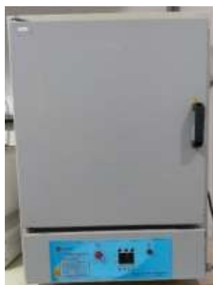
Figura 43: Estufa utilizada para secagem das nanoestruturas de hematita.
