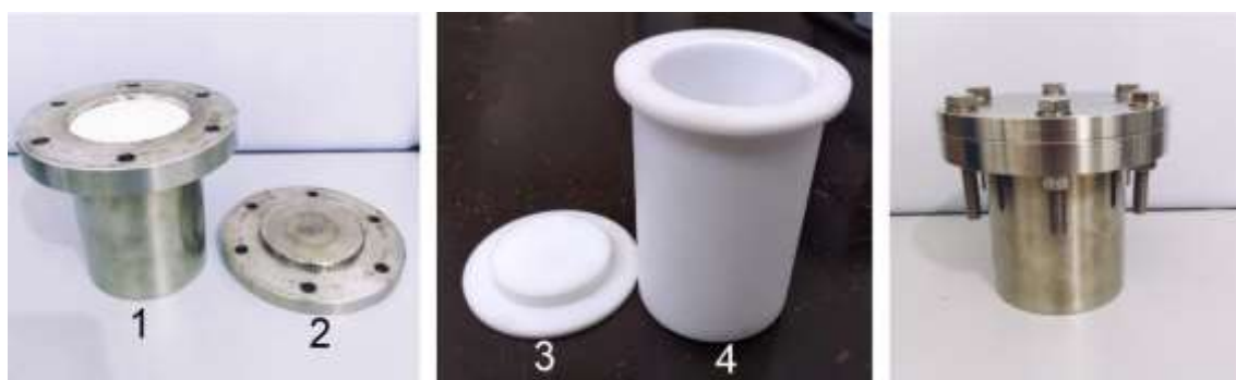
Figura 39: Autoclave desenvolvido para reação hidrotérmica.
