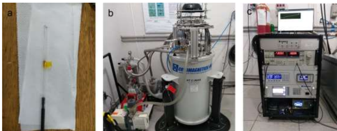
Figura 52: a) Porta amostra; b) e c) Magnetômetro utilizado pertencente ao Grupo GDDM-UEM.
