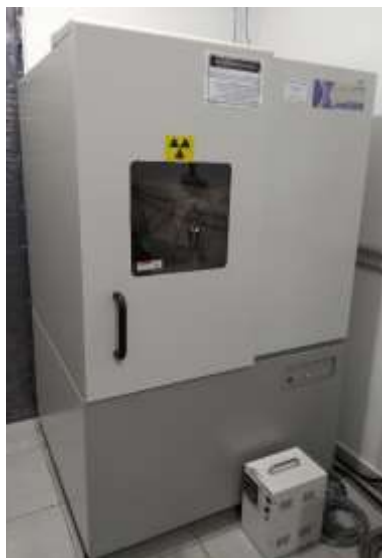
Figura 51: Difratômetro de raios X pertencente ao GDDM-UEM
