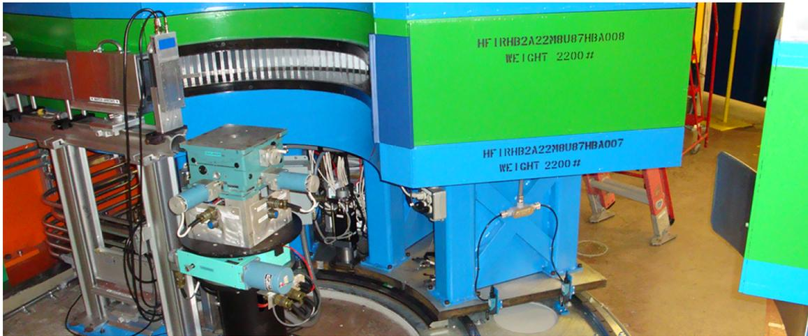
Figura 2.5: Difratorômetro de nêutrons de alta resolução HB-2A. Localizado no reator isotópico de alto fluxo, no laboratório nacional de Oak Ridge. A distância da amostra aos detectores é de 1 m [11].
