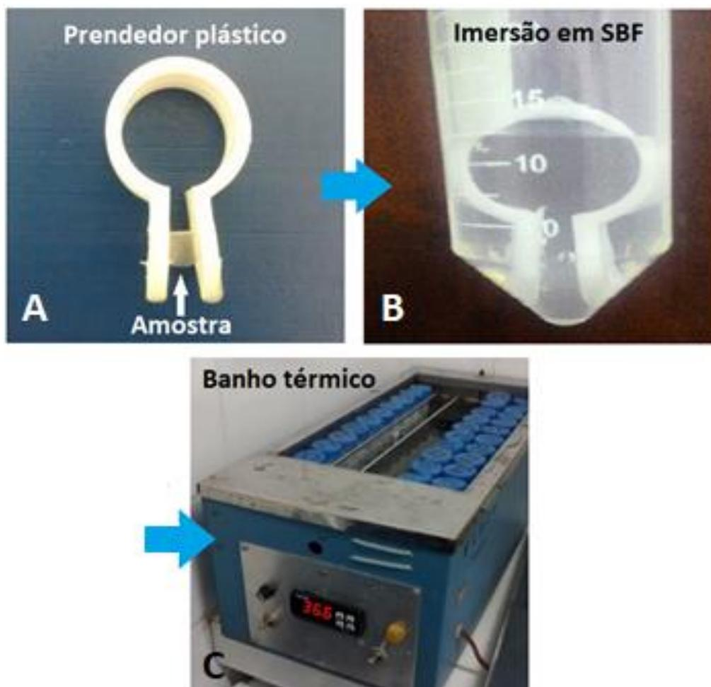
Figura 16: Etapas do procedimento de imersão das amostras. (A) Amostra fixada no suporte para mantê-la verticalmente posicionada durante imersão em SBF. (B) Amostra posta em contato com o SBF dentro do tubo plástico. (C) Amostras resguardadas no banho térmico durante o procedimento *in vitro*.
