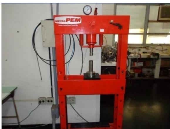
**Figura 12.** Prensa METAL PEM modelo PHP - 30 t, utilizada na confecção das amostras.
