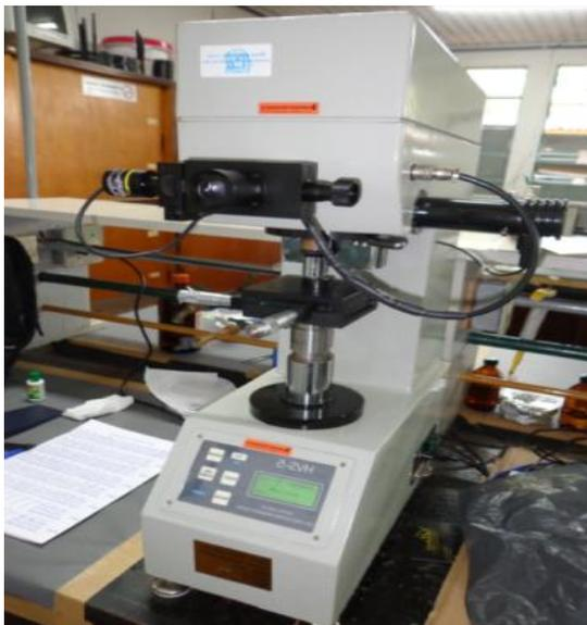
**Figura 15.** Microdurômetro DIGITAL DISPLAY LOW LOAD, Vickers Hardness Tester, Model HVS-5, Serial nº 0040 localizado no DQI/UEM.
