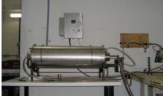
**Figura 13.** Forno tipo tubular com faixa de operação de 100 até 1300 °C, com controle de temperatura e de atmosfera.
