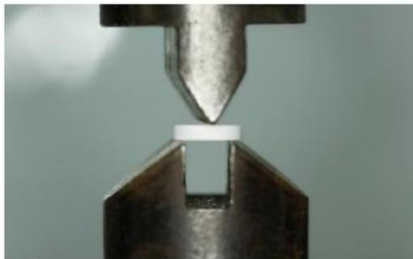
**Figura 18.** Fotografia mostrando o acessório que se adapta à prensa tempopress 2 para o procedimento de fratura das amostras.
