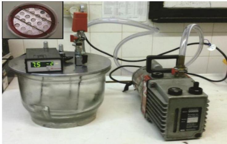
**Figura 14.** Conjunto experimental para a imersão e impregnação das amostras com água destilada para as medidas de densidade e porosidade. Em destaque a bandeja, onde as amostras foram acomodadas.
