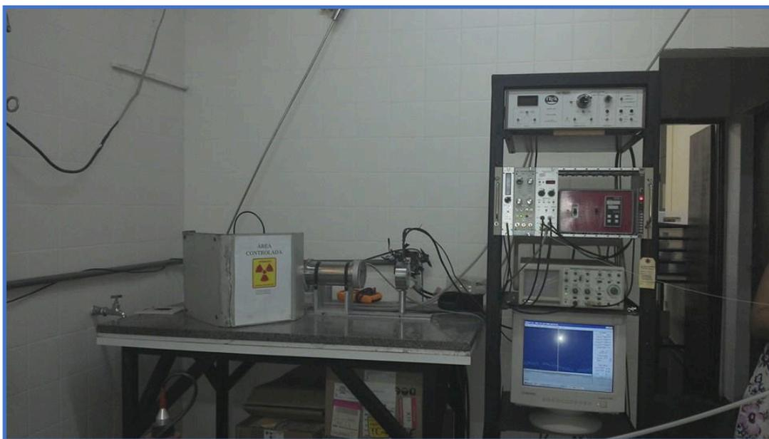
**Figura 3.5:** Espectrômetro Mössbauer com fonte de  $^{57}\text{Fe}$ .
