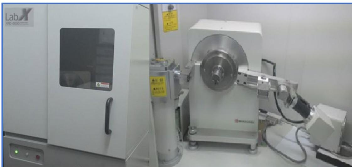
**Figura 3.4:** Difratorômetro de raios X utilizado na análise estrutural (Shimadzu XRD- 6000).
