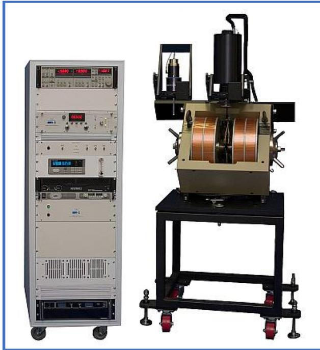
**Figura 3.8:** Magnetômetro de amostra vibrante utilizado nas medidas de magnetização. (EV9 - Microsense)
