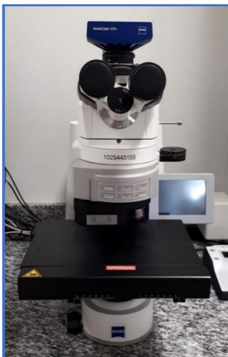
**Figura 3.6:** Microscópio Óptico. (Zeiss, modelo Axio - Imager M2m)
