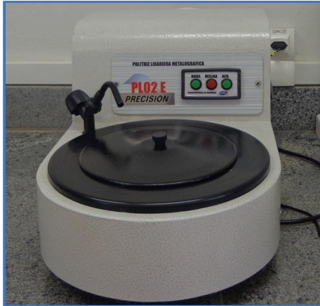
**Figura 3.3:** Lixadeira mecânica utilizada para o ajuste de espessura das amostras.
