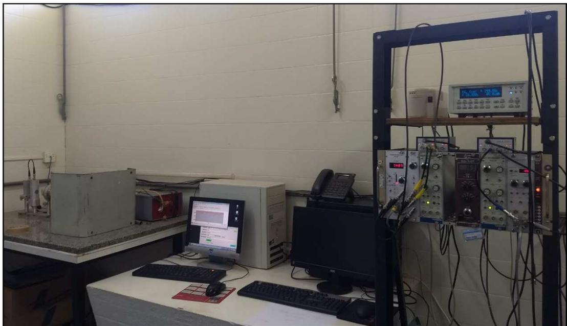
Figura 3.6 – Espectrômetro Mössbauer [51].
