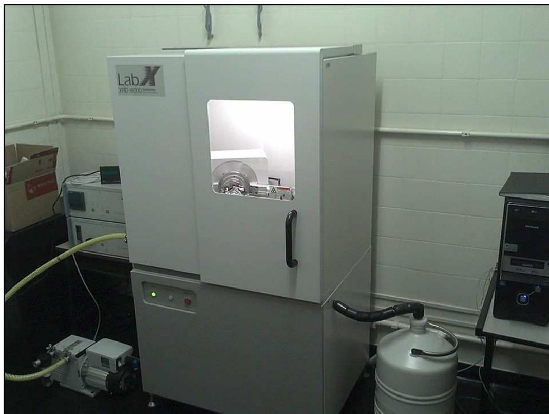
Figura 3.4 – Difratômetro de raios X [51].
