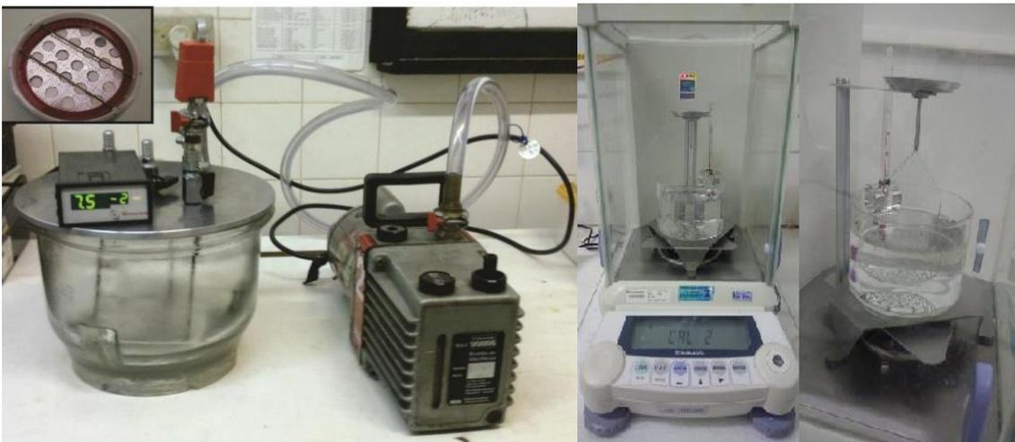
**Figura 13** - Aparato experimental para imersão e impregnação das amostras com água para medidas de densidade a esquerda e balança com o acessório Specific Gravity Measurement Kit utilizado para medir o empuxo a direita.
