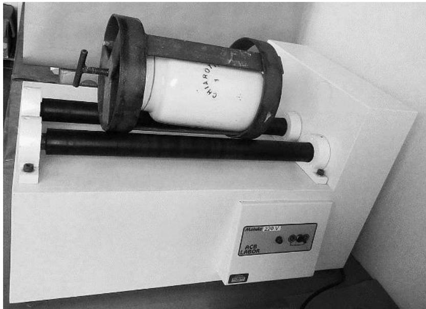
Figura 12 - Moinho da Acb Labor de baixa energia utilizado.
