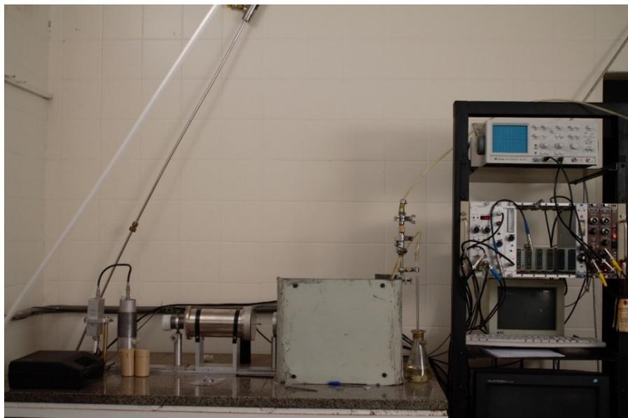
Figura 23 Espectrômetro Mössbauer utilizado para a análise das amostras.
