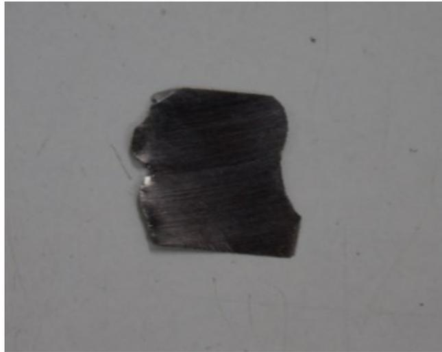
Figura 22 Amostra com espessura diminuída após o lixamento para a Espectroscopia Mössbauer.
