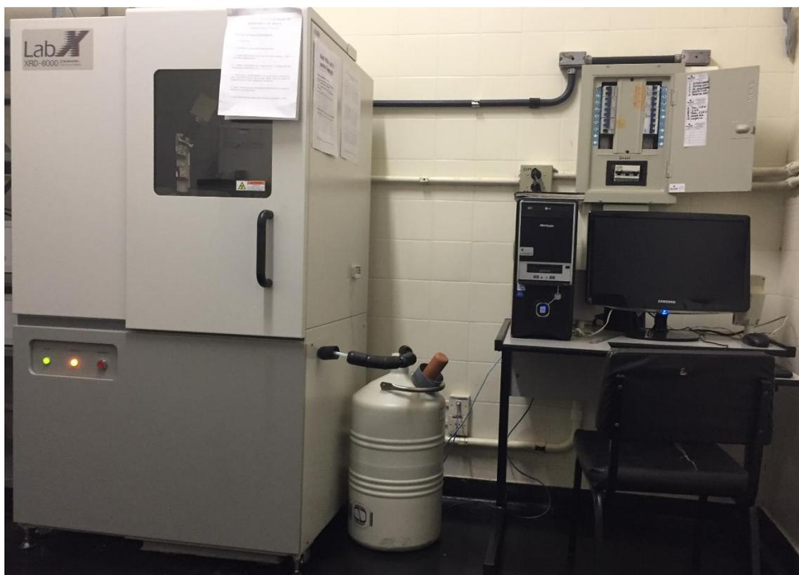
**Figura 3.3:** Imagem do difratômetro da marca Shimadzu, modelo XRD – 6000, utilizado nas medidas de difração de raios-X.
