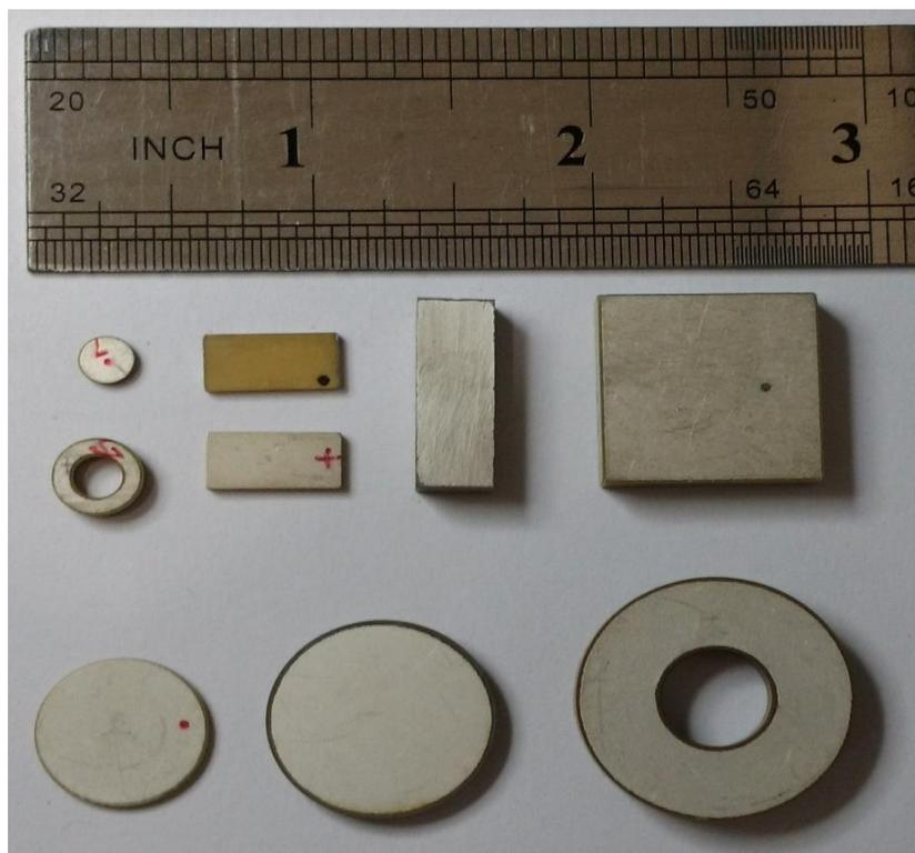
Figura 16: Elementos cerâmicos piezelétricos PZT-5A, polarizados no modo espessura, para diferentes formas e tamanhos.
