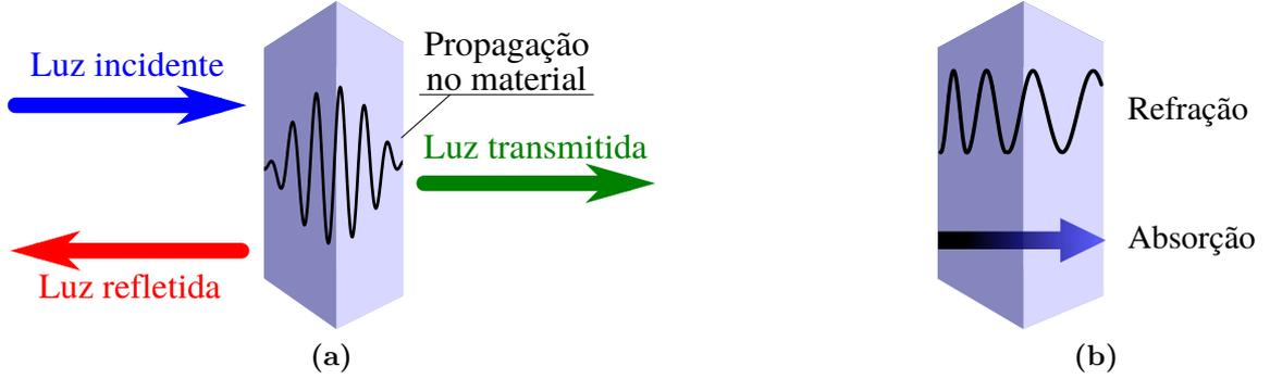
**Figura 3.3:** (a) Reflexão, propagação e transmissão de um feixe de luz incidente em um meio óptico. (b) Alguns fenômenos que podem ocorrer quando um feixe de luz se propagam em um meio óptico. A refração provoca uma redução na velocidade da onda, enquanto a absorção causa atenuação.
