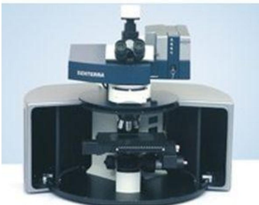
**Figura 4. 3.** Microscópio Raman confocal (Micro Raman).
