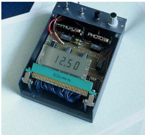
**Figura 1.3** – Primeiro protótipo de um display de cristal líquido TN apresentado por James Fergason, Martin Schadt e Wolfgang Helfrich à diretoria da Hoffmann – La Roche, em março de 1971.
