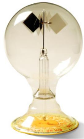
**Figura 2.2:** Radiômetro de Crookes [41].
