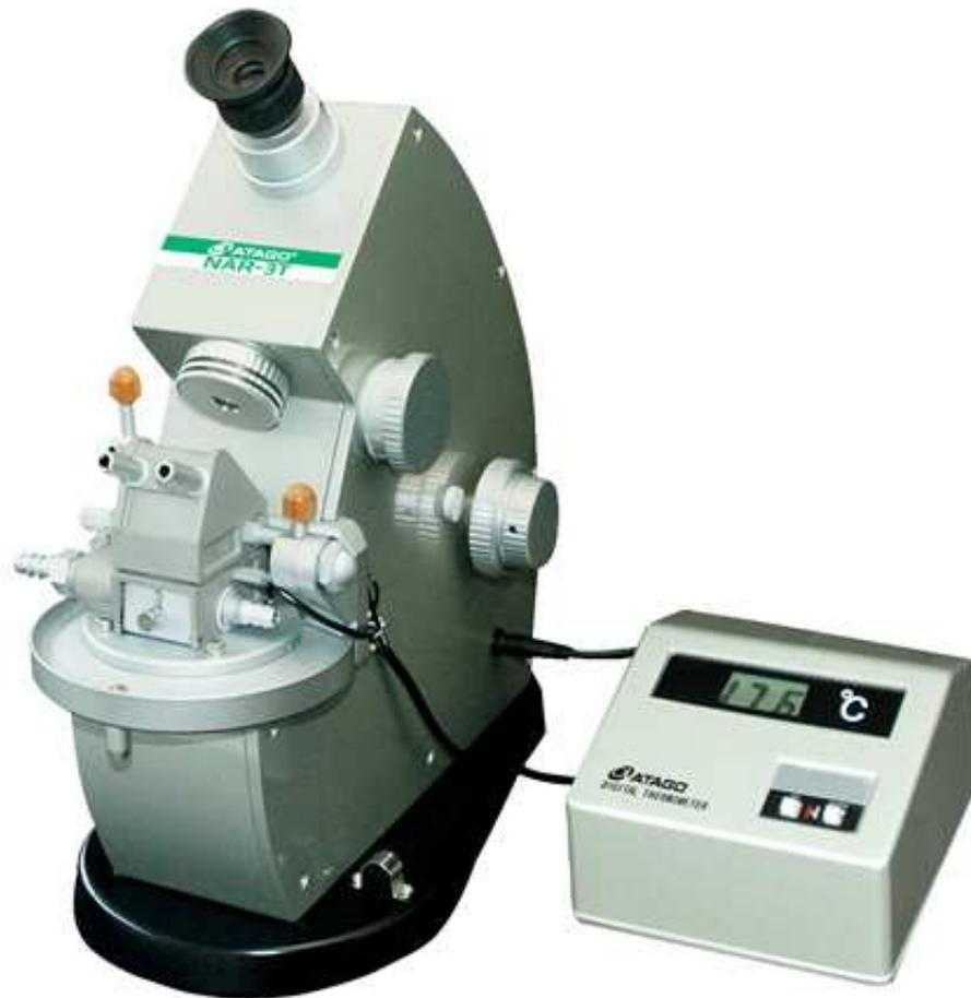
**Figura 3.9:** Refratômetro de Abbe utilizado nas medidas de índice de refração em cristais líquidos.
