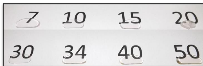
Figura 47: Foto das amostras do vidro aluminosilicato de cálcio co-dopadas com 0.5% de \text{Er}_2\text{O}_3 e 5% de \text{Yb}_2\text{O}_3 e diferentes composições. Os números indicam a concentração de \text{SiO}_2 em % de massa.
