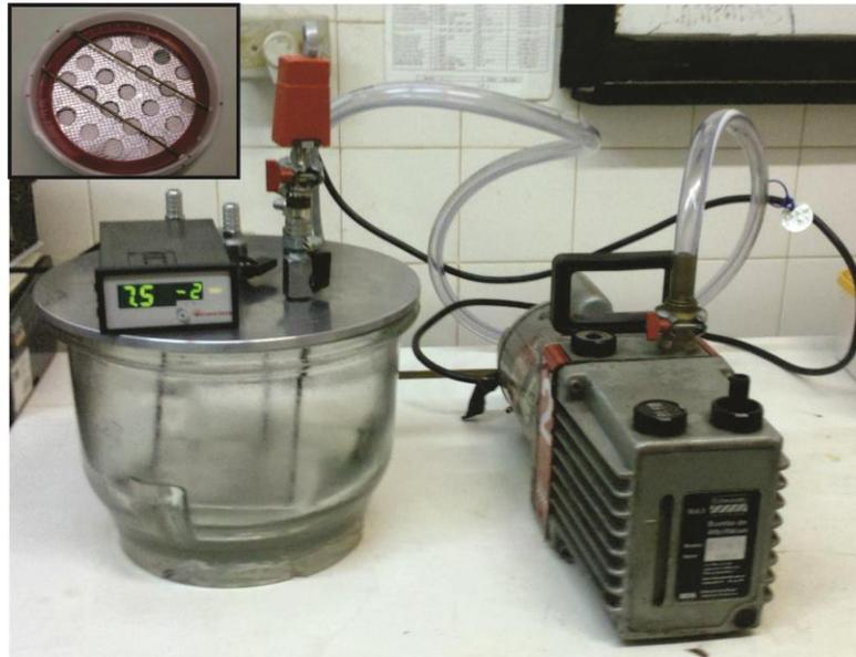
Figura 11. Aparato experimental para imersão e impregnação das amostras com água para medidas de densidade e porosidade. Inserção: Bandeja onde as amostras foram acomodadas.
