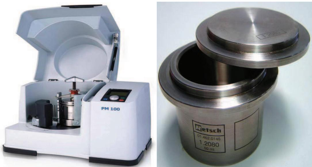
**Figura 5.3** – Moinho do tipo planetário, marca Retsch, modelo PM 100 e vaso de moagem.
