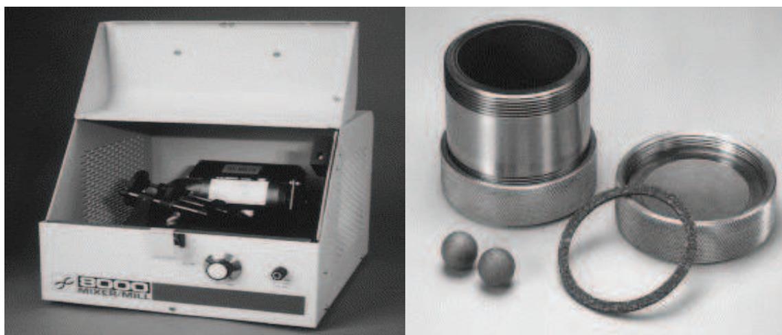
**Figura 5.2** – Moinho do tipo vibratório, marca Spex e vaso de moagem.<sup>1</sup>
