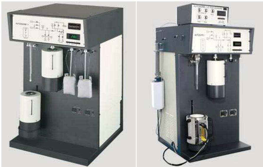
Figura 22: Equipamento de adsorção térmica para medida de área BET.
