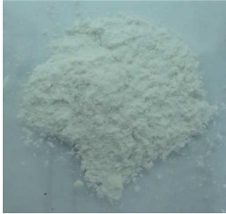
Figura 70:  $\text{Al}_2\text{O}_3/\text{CaO}(0,5)$  – 1000  $^\circ\text{C}$ / 3h Atmosfera - Ar
