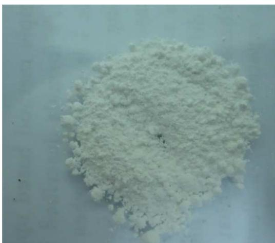
Figura 50: Al<sub>2</sub>O<sub>3</sub>/TiO<sub>2</sub>(0,5) - 1000<sup>0</sup>C/3 h em atmosfera – Ar.
