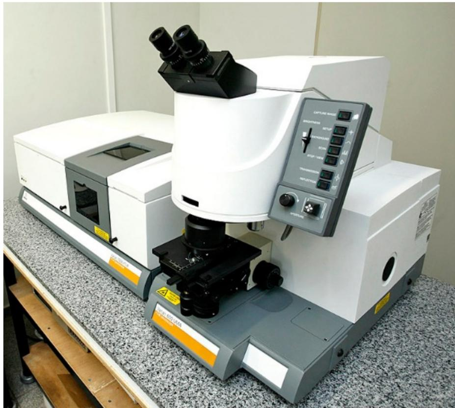
Figura 5.8: Foto do espectroscópio infravermelho por transformada de Fourier com microscópio infravermelho da CAM-COMCAP-UEM.
