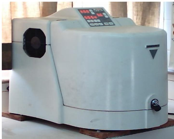
**Figura 28-** Moinho de bolas Fritsch, modelo Pulverisette 6.
