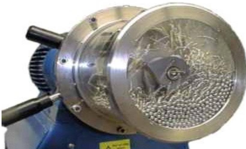
**Figura 27-** Um aparelho de moagem *simoloyer* em funcionamento [19].
