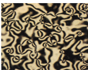
Figura 1.5 - Micrografia da textura de um CLT na fase nemática (figura extraída da referência13).
