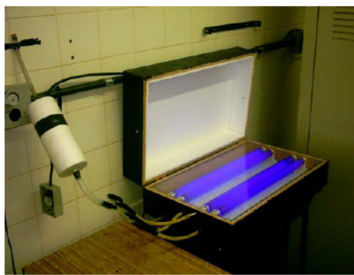
Figura 3.8 - Fotografia da câmara de polimerização UV utilizada na produção de filmes de PDLC[3]
