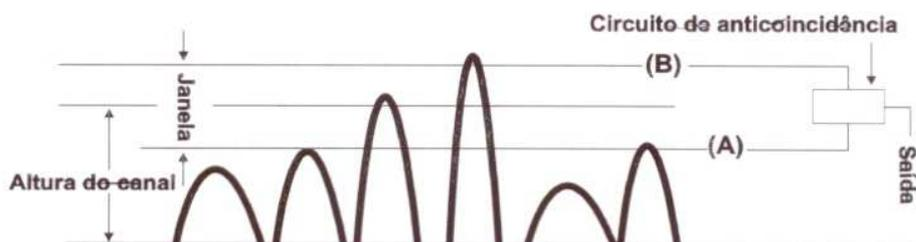
Figura 4.6 - Esquema de funcionamento do analisador monocanal.
