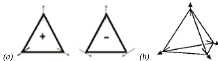
Figura 6: (a) Frustração geométrica na rede triangular para spin forçados a situar-se dentro do plano triangular e (b) estrutura tetraédrica com configuração de spin em 109^\circ [9, 17].
