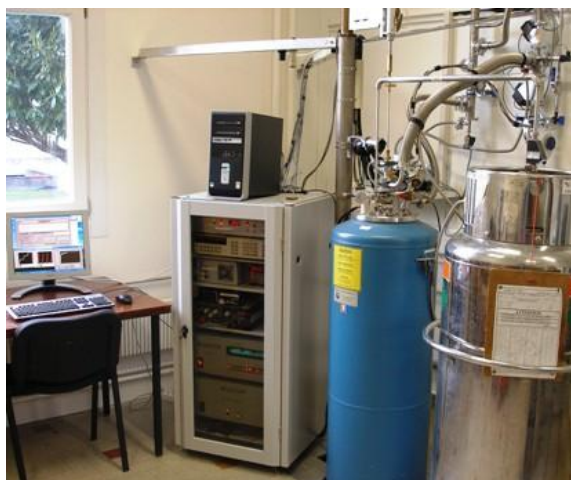
Figura 53: Magnetômetro de extração (BS2) do laboratório do Instituto Néel (CNRS).
