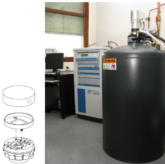
Figura 54: Porta-amostra e equipamento utilizado nas medidas de calor específico.
