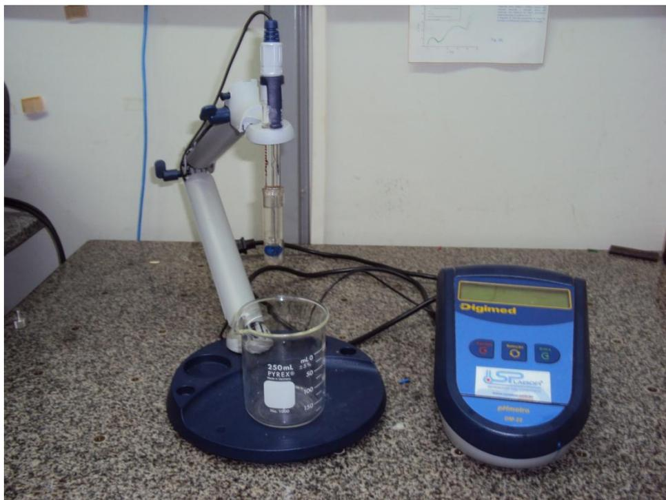
Fig. 3.6 – pHmetro laboratório de fluidos complexos – DFI/UEM. (Digimed; Modelo DM-22).
