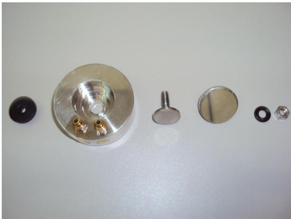
Fig. 3.1 – Componentes dos eletrodos de aço. Da esquerda para a direita temos: anel de guarda, base, placa inferior, placa superior, anel de borracha (*o - ring*) e porca; peças confeccionadas na empresa Marega Ind. Com. Máquinas LTDA, Maringá-PR.
