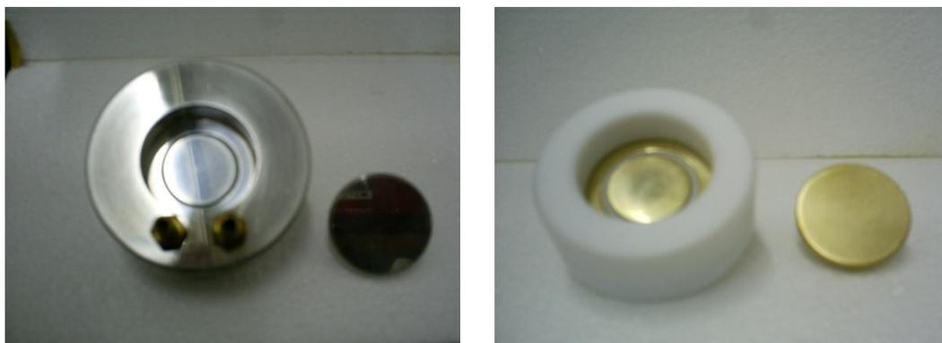
Fig. 3.3 – Eletrodos já montados: o de aço e de latão, respectivamente.
