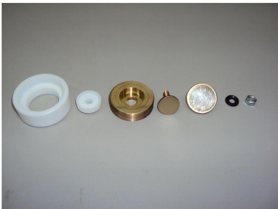
Fig. 3.2 – Componentes dos eletrodos de latão. Da esquerda para a direita temos: contorno da base, anel de guarda, parte metálica da base, placa inferior, placa superior, anel de borracha (*o – ring*) e porca; peças confeccionadas na empresa Marega Ind. Com. Máquinas LTDA, Maringá-PR.
