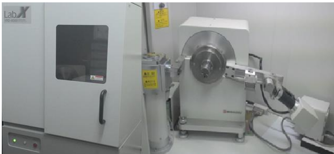
Figura 3.3 – Difrator de Raio-X, Shimadzu XRD- 6000, utilizado na análise estrutural.
