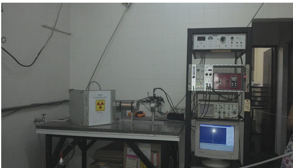
Figura 3.4: Espectrômetro Mössbauer para a fonte de ^{57}\text{Fe} .
