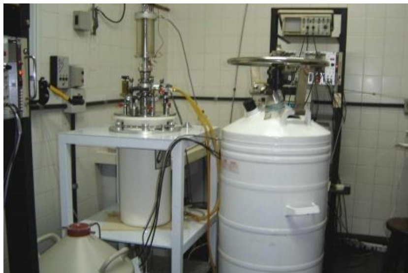
Figura 3.5 – Criostato e reservatório de Hélio para medidas de espectroscopia Mössbauer no ^{155}\text{Gd} .
