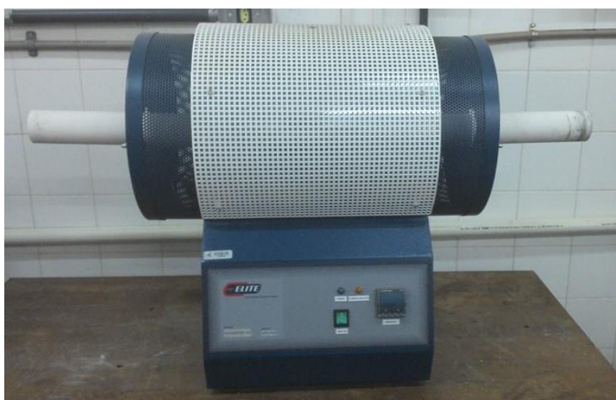
Figura 3.2 – Forno tubular utilizado para os tratamentos térmicos em T = 1100^{\circ}\text{C} .
