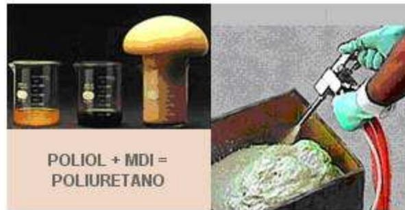
*Figura (8-IV): Reação química a partir da qual se obtém a PUF.*
