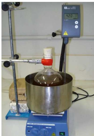
*Figura II.4: Óleo no balão de vidro aquecido por banho térmico de silicone com agitação magnética.*
