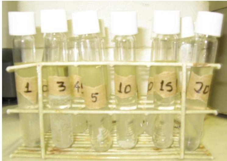
*Figura II.5: Tubos de ensaio contendo a mistura óleo/álcool/catalisado de diferentes períodos de reação em solução de HCL.*
