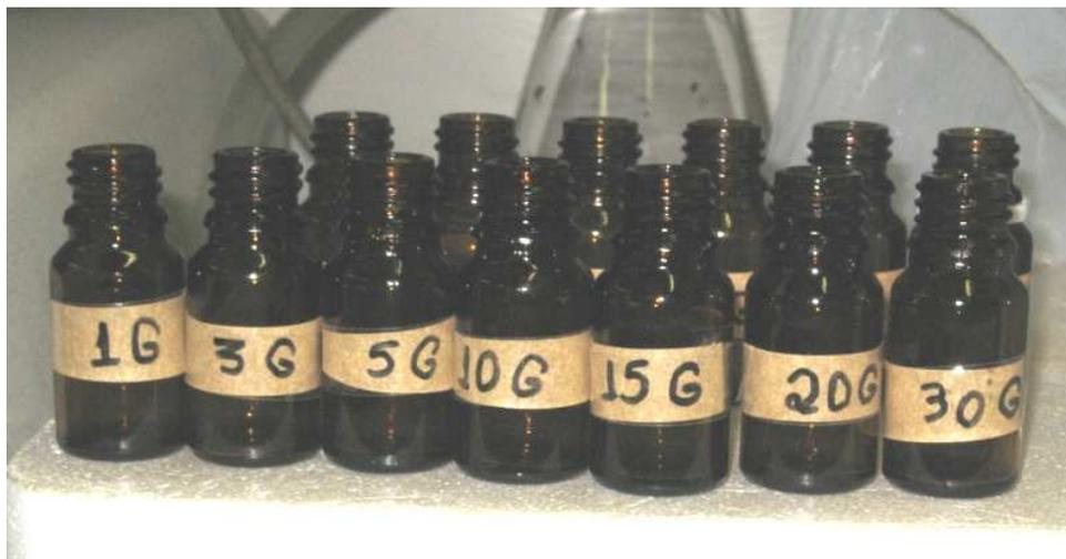
*Figura II.7: Frascos contendo o biodiesel pronto para análise após separação da glicerina e evaporação do excesso de álcool.*
