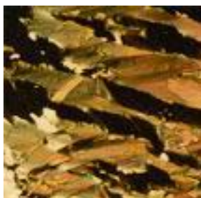
Figura 2.10: Textura de um cristal líquido na fase esméctica C [10].
