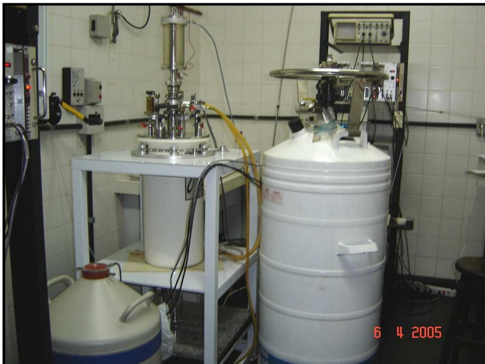
**Figura 3.5: Montagem experimental utilizada para medidas Mössbauer em baixas temperaturas.**
