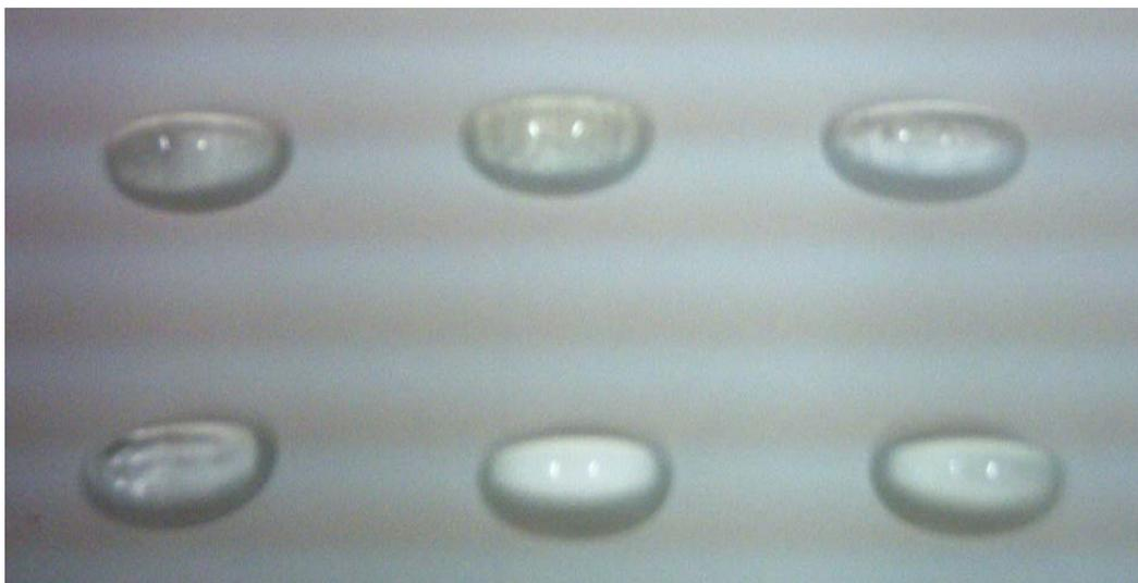
Figura 5.4. Amostras do vidro LSCAS co-dopadas com  $\text{Yb}^{3+}$  e  $\text{Tm}^{3+}$ .
