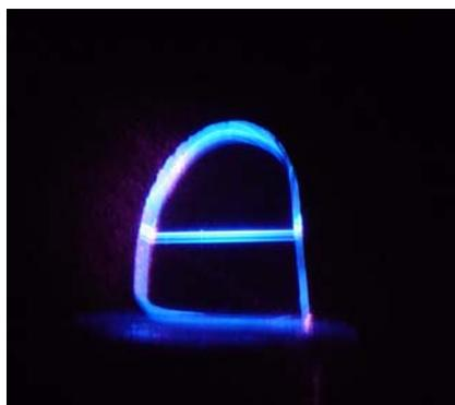
Figura 8.7 - Fotografia da amostra co-dopada com 2% de  $\text{Yb}_2\text{O}_3$  e 0,5% de  $\text{Tm}_2\text{O}_3$ .
