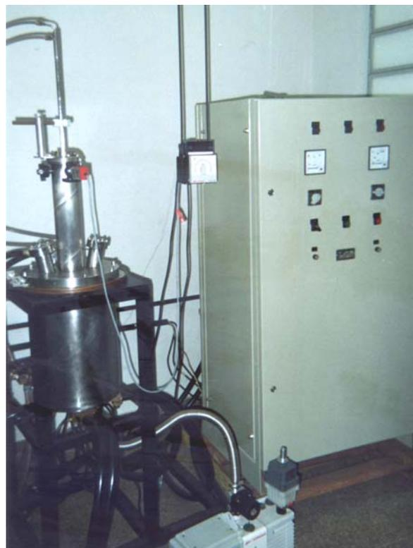
Figura 5.3. Foto do forno utilizado para a produção das amostras a vácuo.
