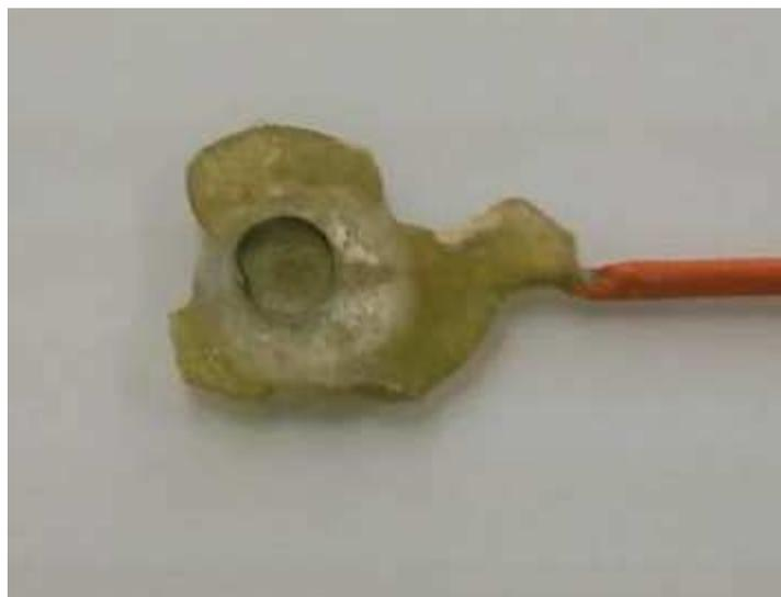
Figura 5.2 Foto de uma célula depois de uma hidrogenação eletroquímica
