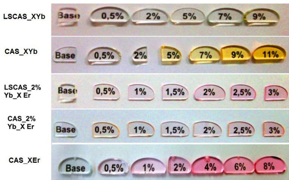
Figura 3.2 – Fotos das amostras após corte e polimento
