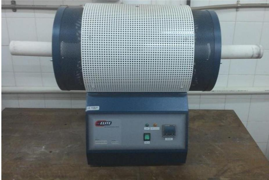
Figura 3. 2-Forno tubular utilizado no tratamento térmico à 1500 °C
