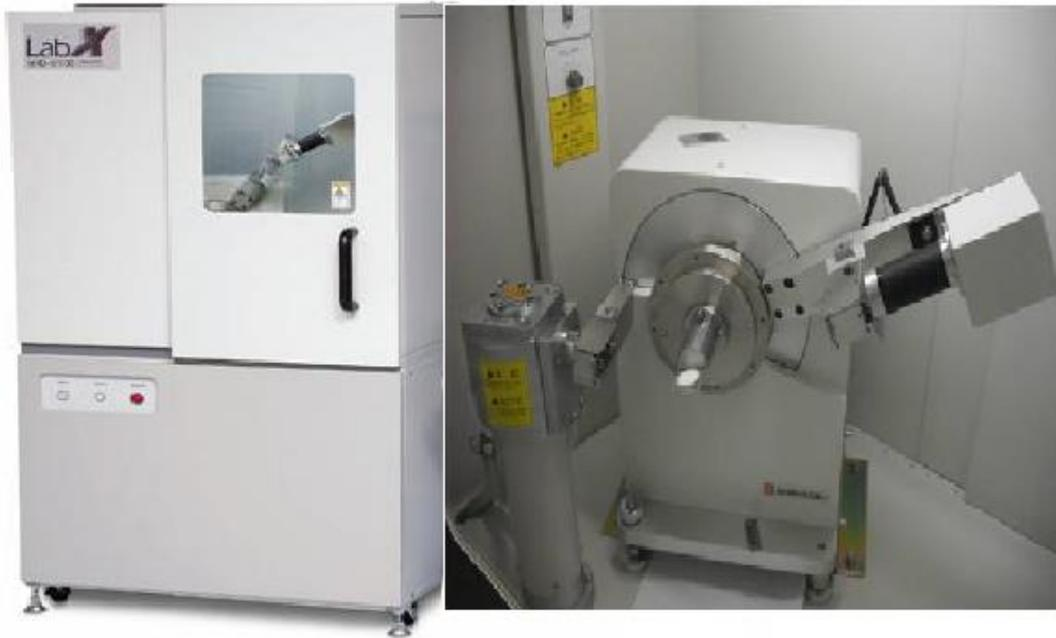
*Figura 3.3- Difratômetro de raios X utilizado na identificação das fases*
