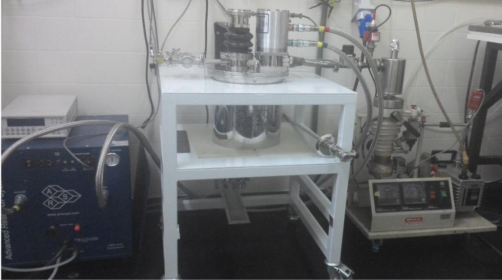
*Figura 3.5-Criostato de He líquido*
