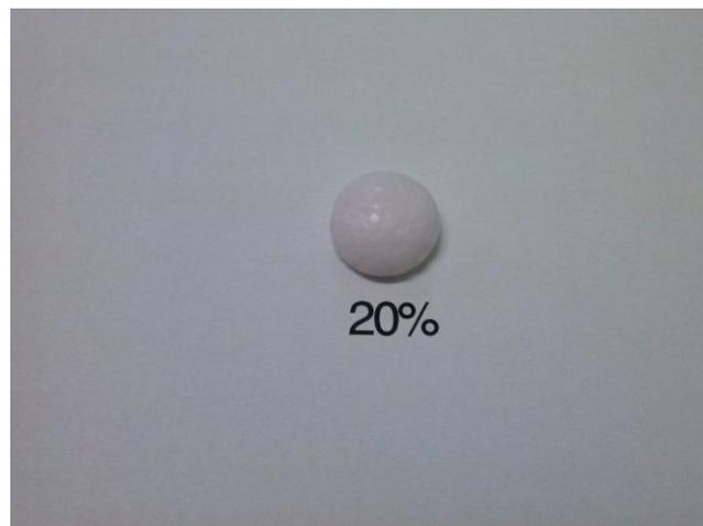
Figura 14: Foto da amostra com concentração de 20% de sílica em massa, que não vitrificou.
