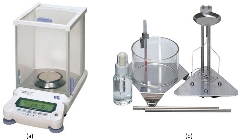
Figura 15: imagem (a) balança analítica marca Shimadzu, AUW220D, com precisão de 0.01mg, imagem (b) equipamentos utilizada para medir a densidade das amostras, principalmente o suporte para medida da massa em ar e submersa no Becker de laboratório com água destilada, e o termômetro para medir a temperatura da água e conferir na tabela que consta no manual a respectiva densidade do líquido. [77]
