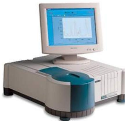
Figura 3.13: Espectrofotômetro UV-Vis Cary-50.
