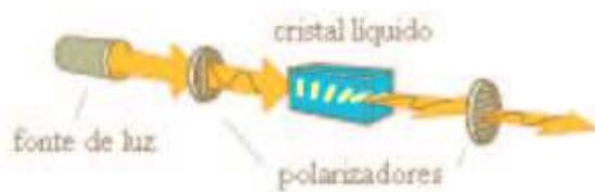
Figura 3.3: *Esquema de uma amostra de cristal líquido entre dois polarizadores mudando o plano de polarização da luz.*
