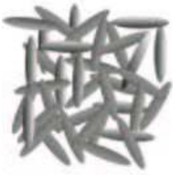
Figura 1.10: *Representação esquemática da mesofase isotrópica.*
