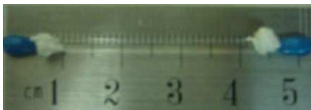
Figura 3.4: Capilar de  $200\mu\text{m}$  de espessura contendo nossa amostra de cristal líquido liotrópico. A vedação deste capilar foi feito com parafilme e uma camada de esmalte.
